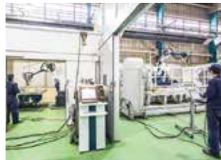
ロボットアームによる溶接
