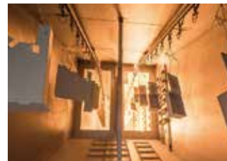
トローリーから大型乾燥炉へ
